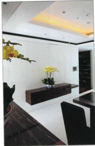
1.設計師特別在白色壁面上以纖細的線條作裝飾，除了可以增加細膩的設計感外，同時在壁面後半段也將客用衛浴間的門片做無把手設計，使門片的縫隙隱藏在眾多線條中。
